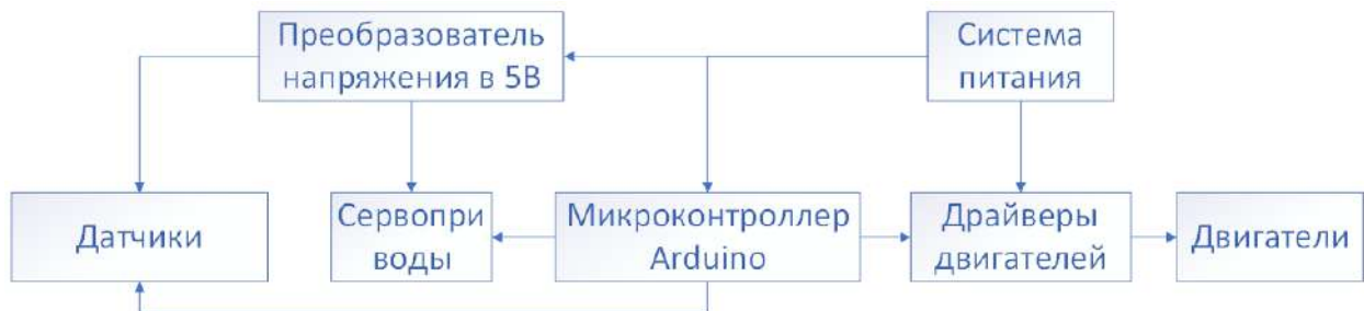
Рис.6. Схема шасси тележки
