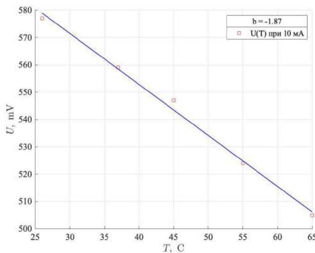
З 1.50 По графику зависимости  $U_x(T)$  определите ТКН диода.
