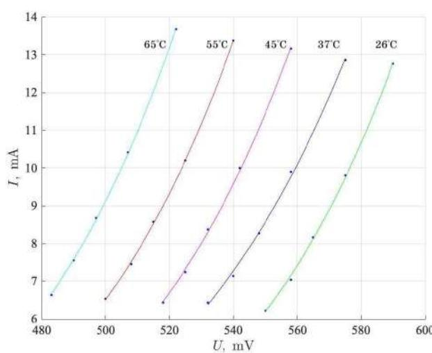
2 3.50 По результатам измерений постройте график (формат А5) зависимости напряжения на диоде  $U_x$  от температуры  $T$  при силе тока  $I_x = 10\text{mA}$ .
