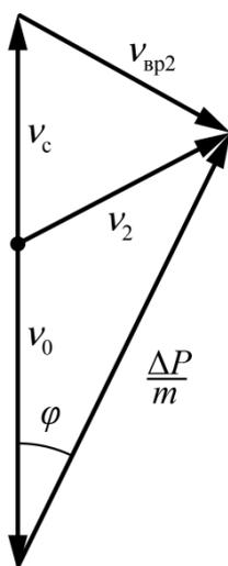
Поскольку стержень невесом, а время удара мало, изменение импульса верхнего шарика  $\vec{\Delta P}$  направлено вдоль стержня. Представим скорость этого шарика двумя способами:
