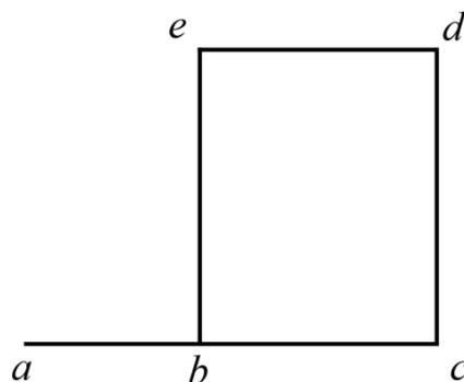
**Возможное решение.** Поскольку все отрезки параллельны координатным осям  $Q$  и  $T$ , на рисунке представлен цикл Карно. Отрезки  $cd$  и  $eb$  не могут быть параллельны оси  $Q$ , иначе в точке  $b$  температура отличается от температуры точки  $a$ , а это невозможно в циклическом процессе. Поэтому  $abc$  и  $de$  параллельны оси  $Q$ , а  $cd$  и  $eb$  – оси  $T$ . Ось температур должна проходить через точку  $a$ , так как с неё начинается отсчёт подведённой теплоты.
