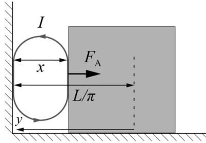
Обратим внимание, что поведение разгоняющей силы в точности совпадает с поведением силы упругости пружины длиной  $L/\pi$  с коэффициентом жёсткости  $k = \pi IB/2$ . Поэтому движение в процессе разгона соответствует четверти периода гармонических «колебаний» на пружине от начальной деформации  $y_0 = \frac{L}{\pi} - x_0$  до «положения равновесия». Максимальная скорость разгона
