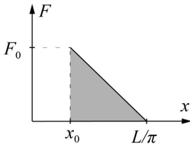
Другой способ вычисления максимальной скорости – это использование закона изменения кинетической энергии. Поскольку сила, действующая на куб, зависит линейным образом от его перемещения, то её работу можно вычислить как площадь под графиком  $F(x) = IB(L - \pi x)/2$ .
