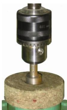
Рис. 1. Крепления оправки для полировки
